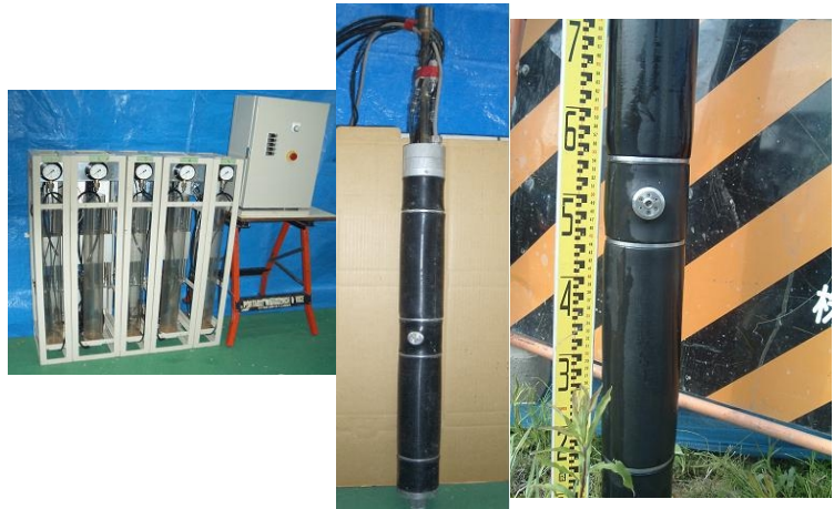
写真-1 5連ポンプと5セル型プレッシャメータ
