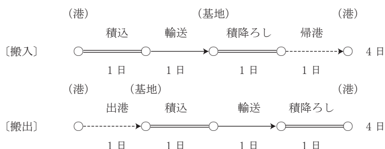
海上輸送による鋼製櫓運搬工程図
