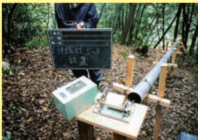
伸縮計設置状況
