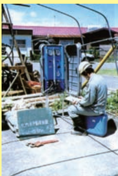
孔内水平載荷試験
