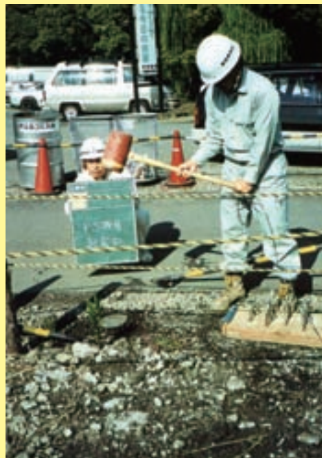
PS 検層（板たたき法測定状況）
