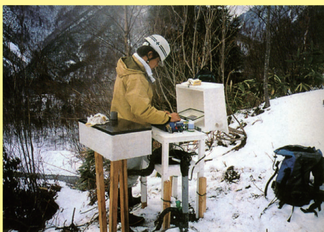
自記式水位計（半自動観測）設置状況
