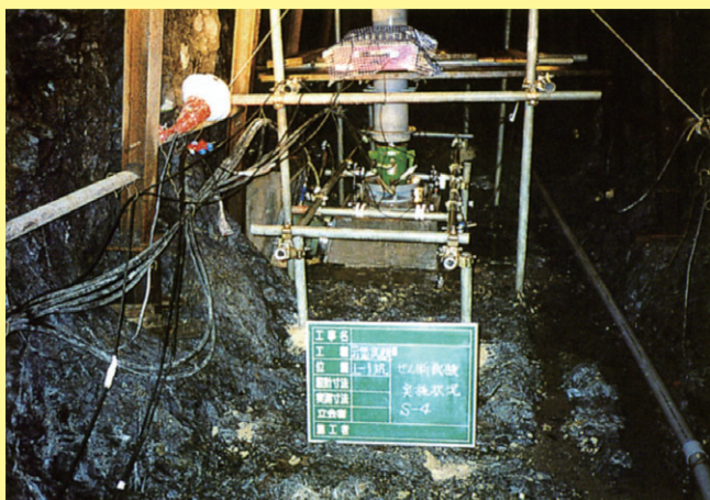
横孔内での岩盤せん断試験
