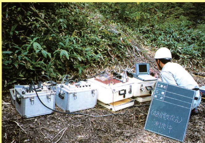
高密度電気探査法による測定
