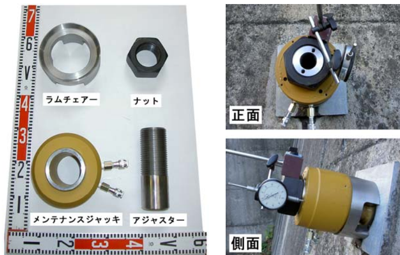
写真-2.2 SAAMジャッキとアンカーへの装着状態
