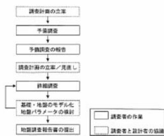
図3 地盤調査から構造設計へのフロー
