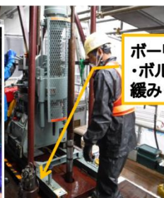
掘進時、 スピンドル開閉部 巻込まれ防止措置 (安全カバー装着) 【オプション】
