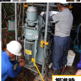
掘進時、 スピンドル開閉部 巻込まれ防止措置 (安全カバー装着) 【オプション】
