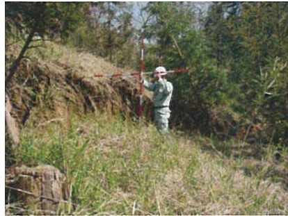
写真 - 12 滑落崖最上部と残存土塊との間の段差 (福島県より提供)
