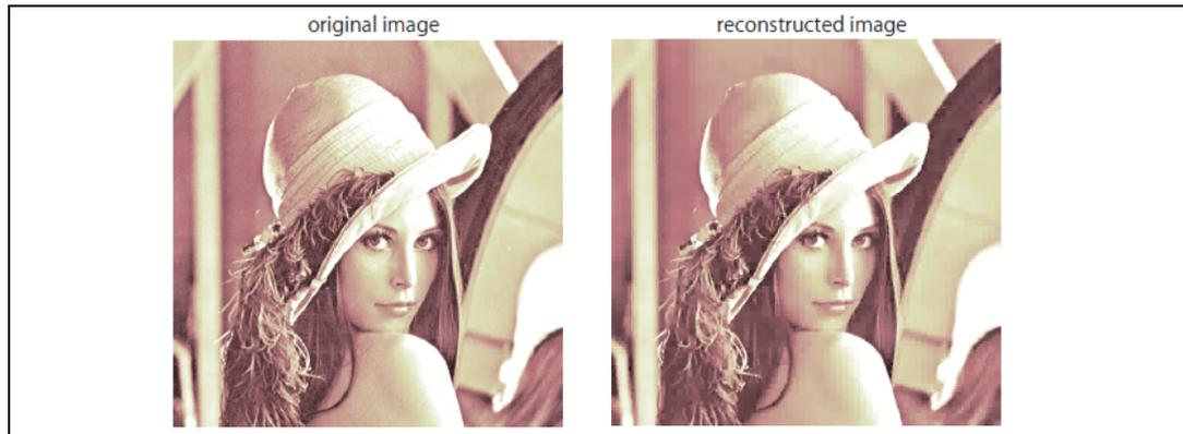
図 7.3.2-2 原画像と絶対値の小さいものから 95% のウェーブレット係数を 0 にしたもののからの再構成結果の比較
