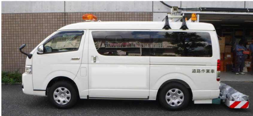
写真 4.3.1 パルス式レーダシステム 車載型路面下空洞探査車
