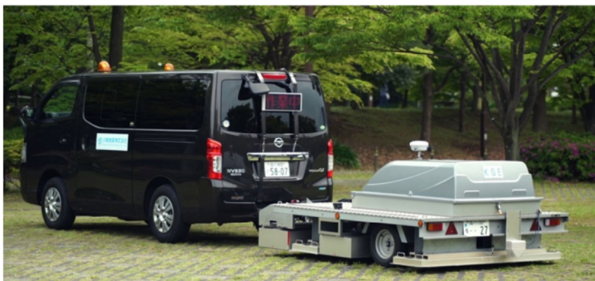
写真 4.3.2 チャープ式レーダシステム 牽引型路面下空洞探査車
