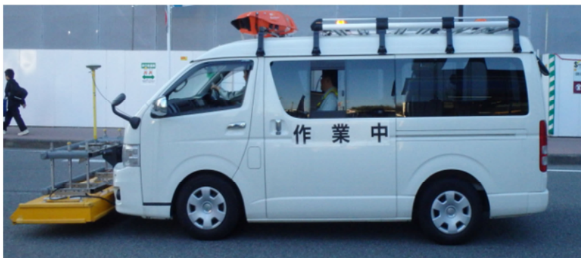
写真 4.3.3 3Dレーダシステム 車載型路面下空洞探査車
