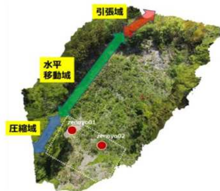
図-1 A地区のSfMによる立面図(2023年3月28日撮影)
