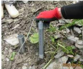
単管パイプで30cmの深さの穴をあけて、傾斜計を直接埋め込む
