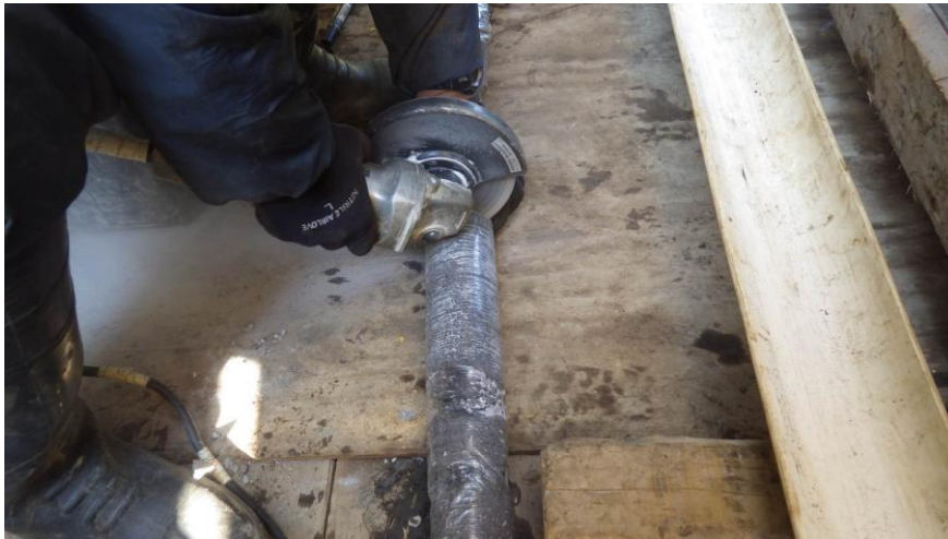
写真 10-2 ボーリングコアの切断状況
