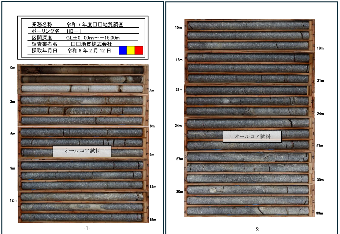
図 8-5 連続ボーリングコア写真の整理例 (3)
