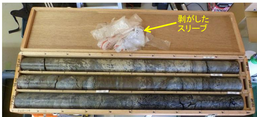
写真 10-7 スリーブを剥がした状態
