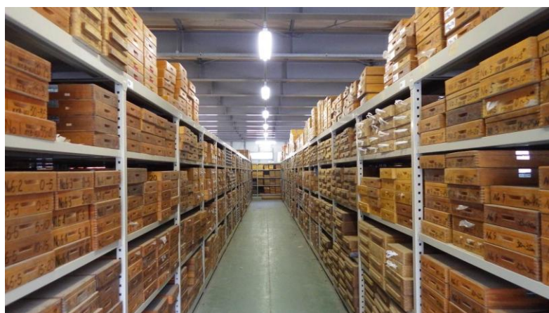
写真 10-15 ボーリングコアの保管状況
