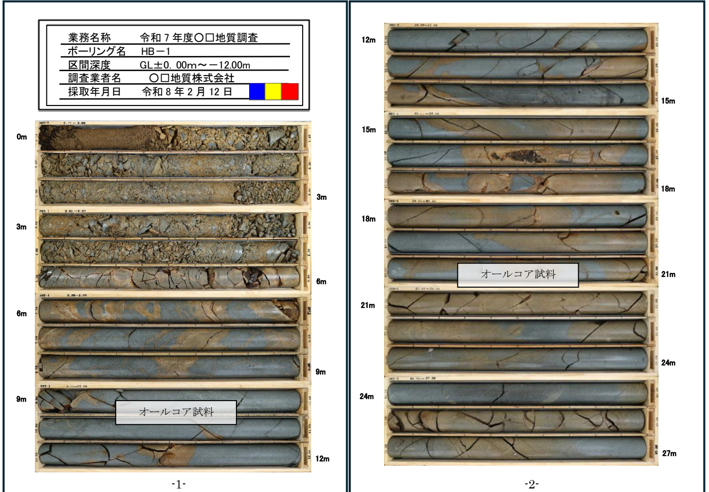
図 8-6 連続ボーリングコア写真の整理例 (4)
