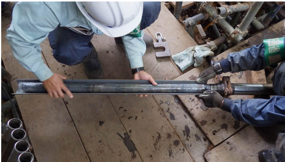
写真 10-1 コアチューブからの取り出し状況
