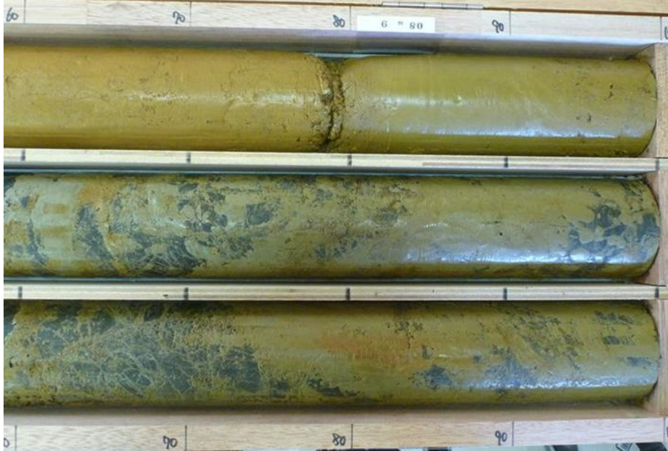
写真 10-11 洗浄前のマッドケーキ付着状況
