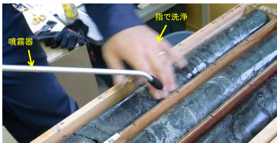
写真 10-9 噴霧器と指を使った洗浄 (指の感覚でボーリングコアをなぞるようにして、表面に 付着したスライムやマッドケーキを洗い落とす。)
