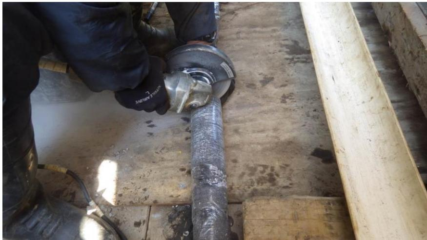
**写真10-2 ボーリングコアの切断状況**
