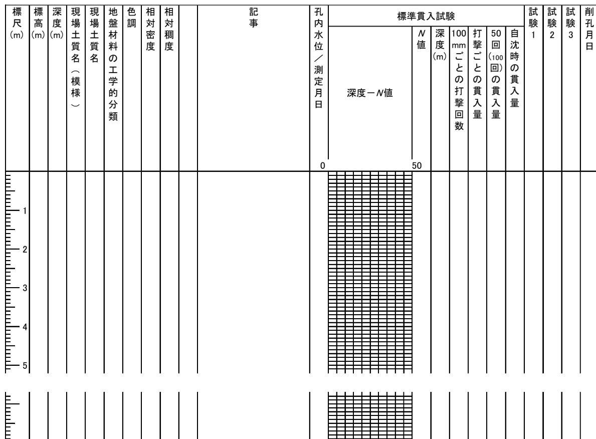
図5-1 土質ボーリング柱状図様式（標準貫入試験用）
