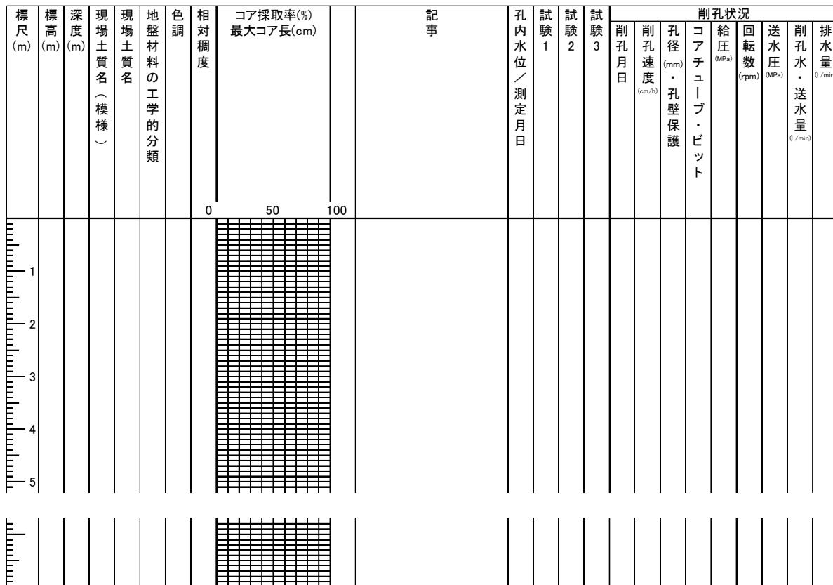
図4-1 土質ボーリング柱状図様式（オールコアボーリング用）
