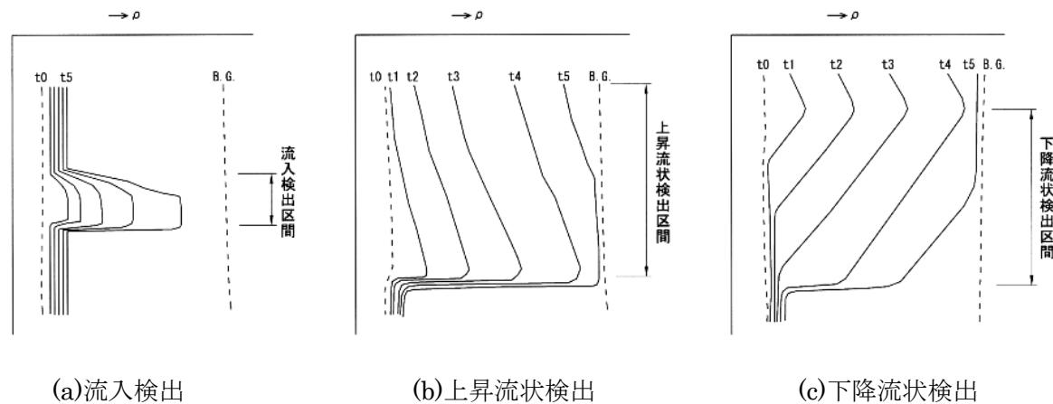
図 6-2 地下水検層結果の判定
