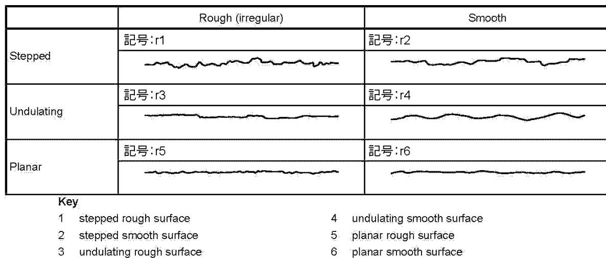
図3-3 不連続面の粗さの区分の例（ISO<sup>4)</sup>に加筆）
