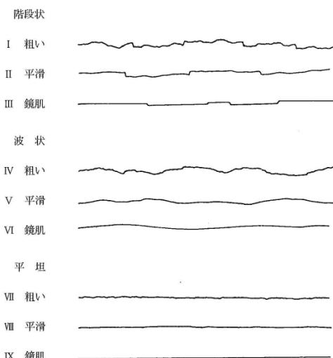
図3-2 不連続面の粗さのカテゴリーの代表断面 (IAEG<sup>2)</sup> を翻訳)表3-31 不連続面の粗さの区分の例<sup>3)</sup>
