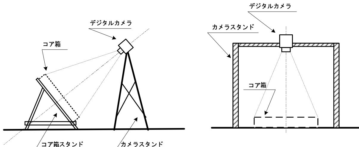
図8-2 ボーリングコア写真的撮影方法例
