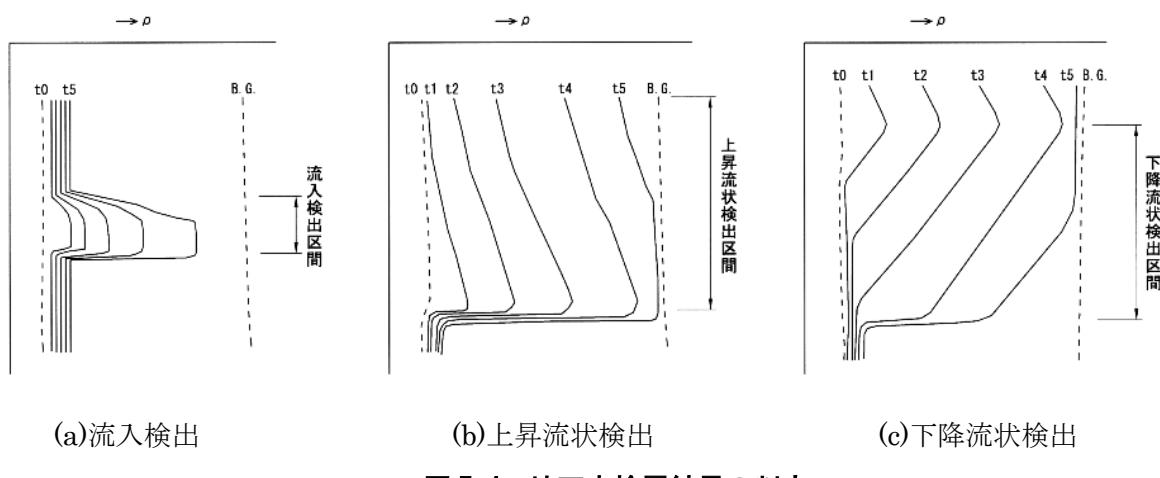
図7-4 地下水検層結果の判定
