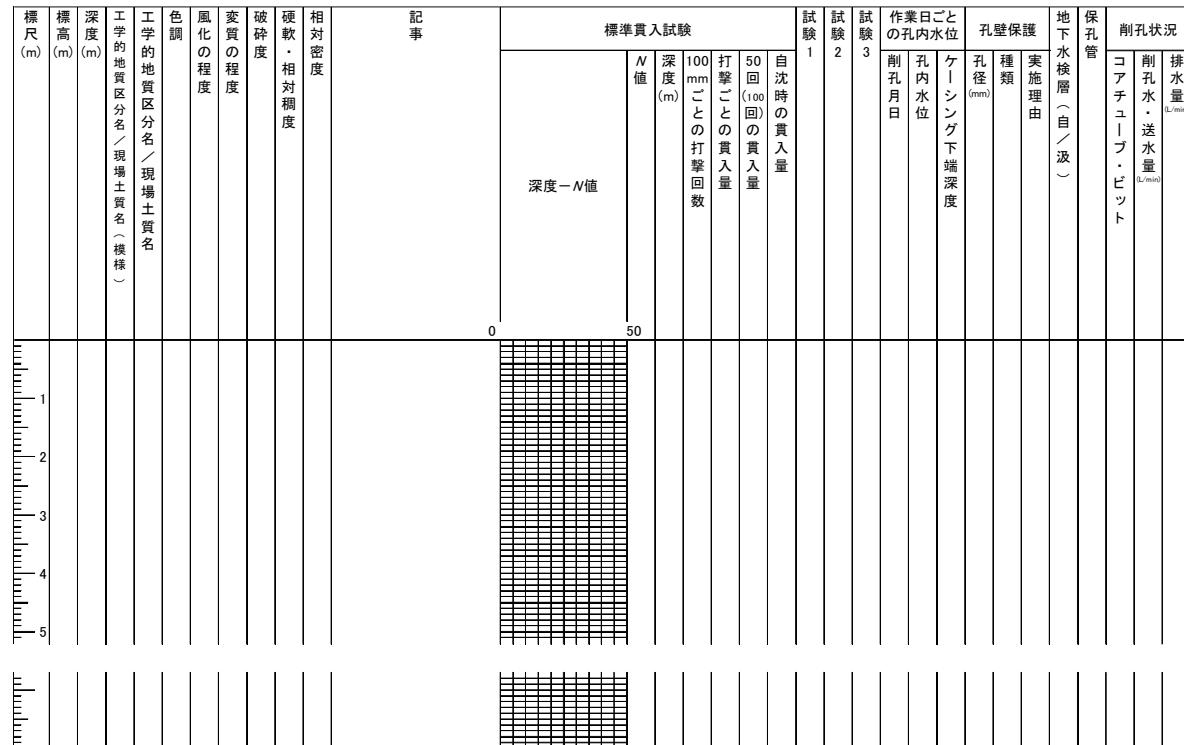
図7-1 地すべりボーリング柱状図様式(標準貫入試験用)
