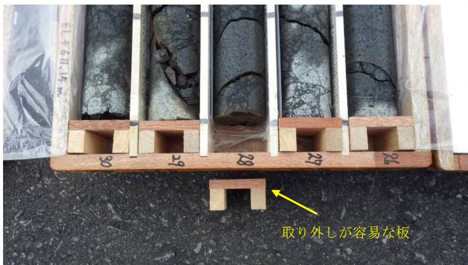
写真 10-3 箱右端伸びしろへの板の挿入例
