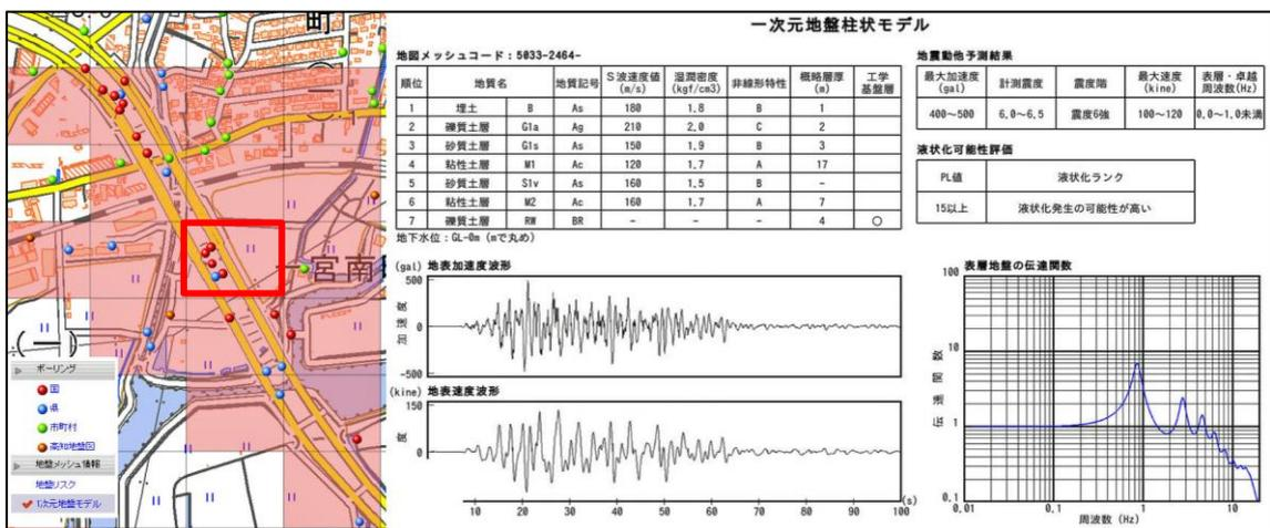
図 6-34 表層地盤の動的モデルと地震動シミュレーションの結果例 (イメージ:非公開)
