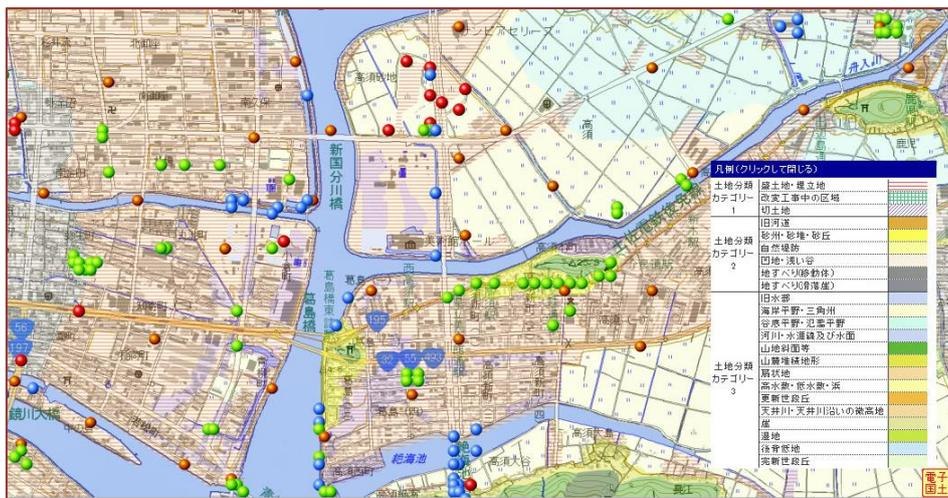
図 6-35 表層地盤モデルを作成する際に使用する土地条件図の例
