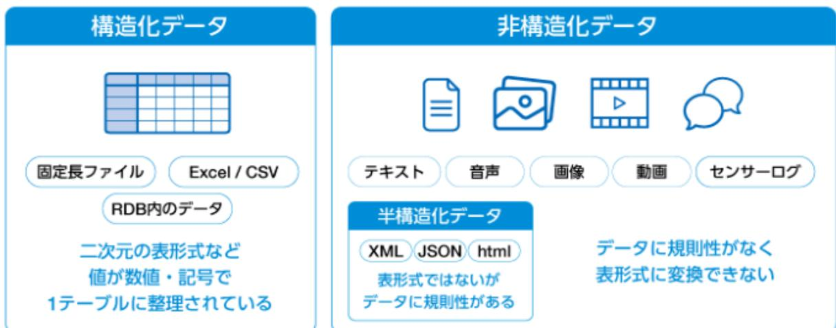
図 1-5 構造化データと非構造化データ
