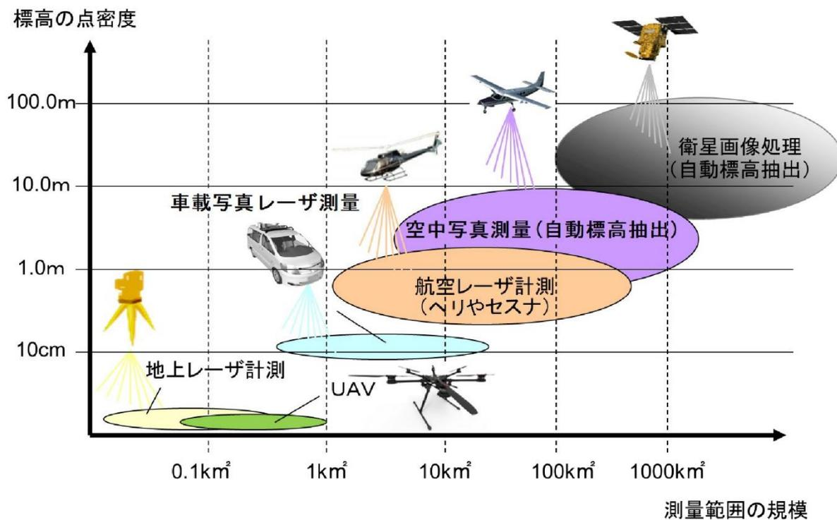
図 2-7 3次元測量手法の点密度と適用範囲
