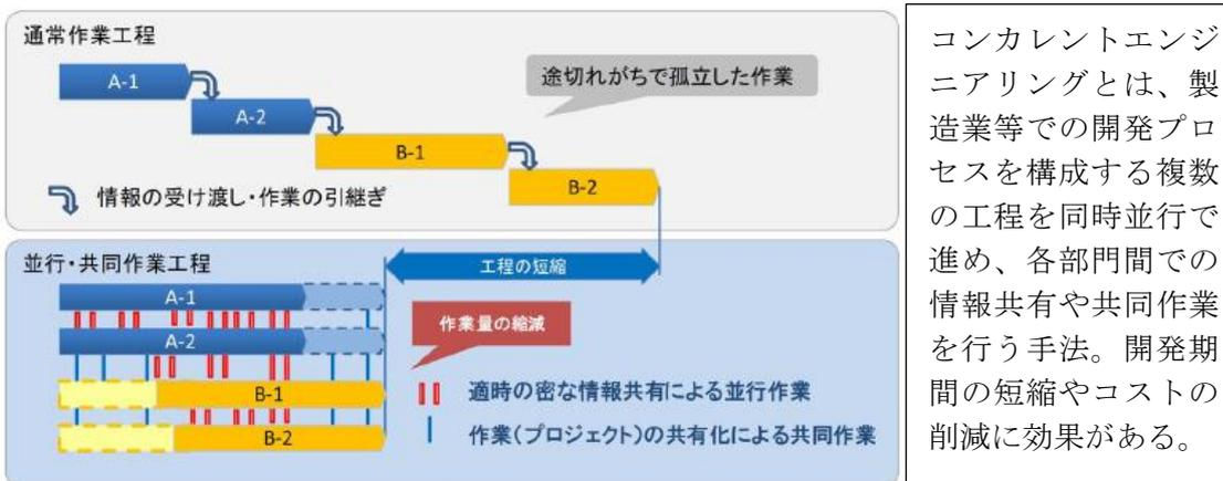
図 5-12 コンカレントエンジニアリング（並行作業・共同作業）による効果のイメージ
