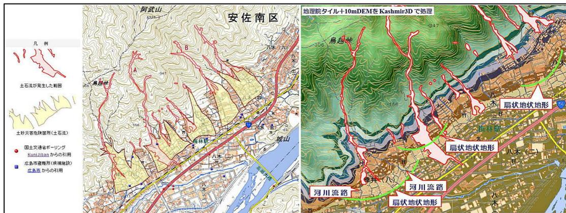
(左) 土砂災害危険箇所図+土石流範囲図
