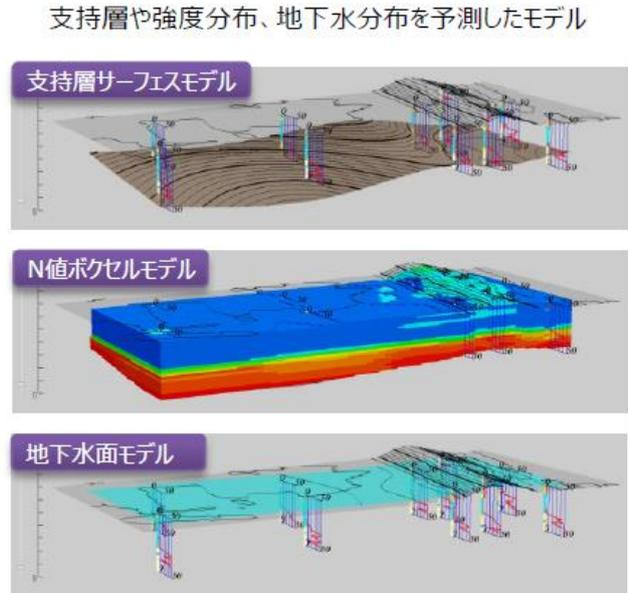
図 4-9 目的に応じたモデルの作成例
