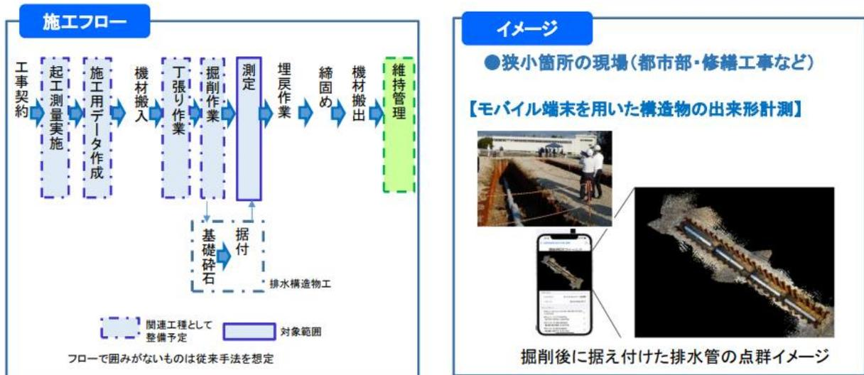
図 1-54 小規模現場への ICT 適用拡大：モバイル端末を用いた構造物の出来形計測
