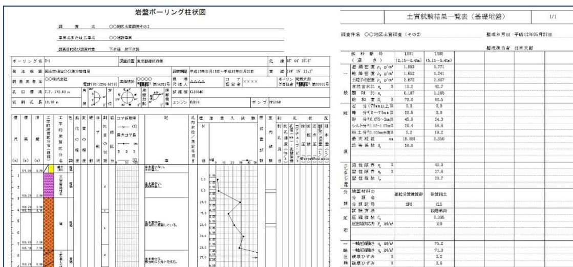
(左) ボーリング交換用データ(XML : DTD400)を柱状図ビューアで図化した例
