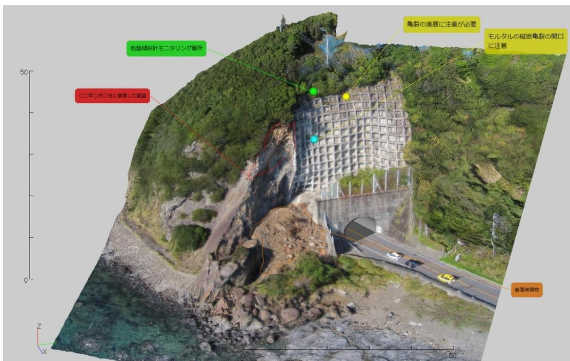
図 2-53 斜面点検を想定した地質リスクの表示（例）
