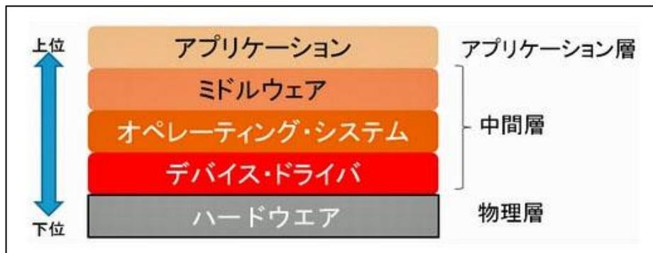
図 1-2 パソコンにおける一般的なソフトウェアの階層構造(イメージ)
