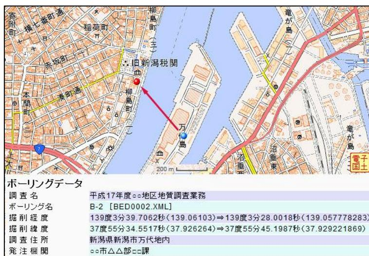
図 1-35 旧測地系による位置情報から新測地系による位置情報に変換処理した例
