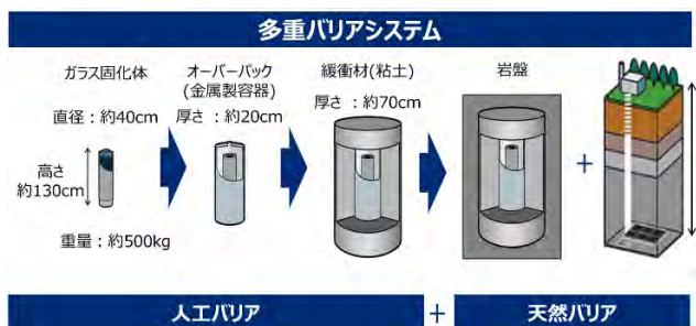
図3 高レベル放射性廃棄物に対する多重バリアシステム
