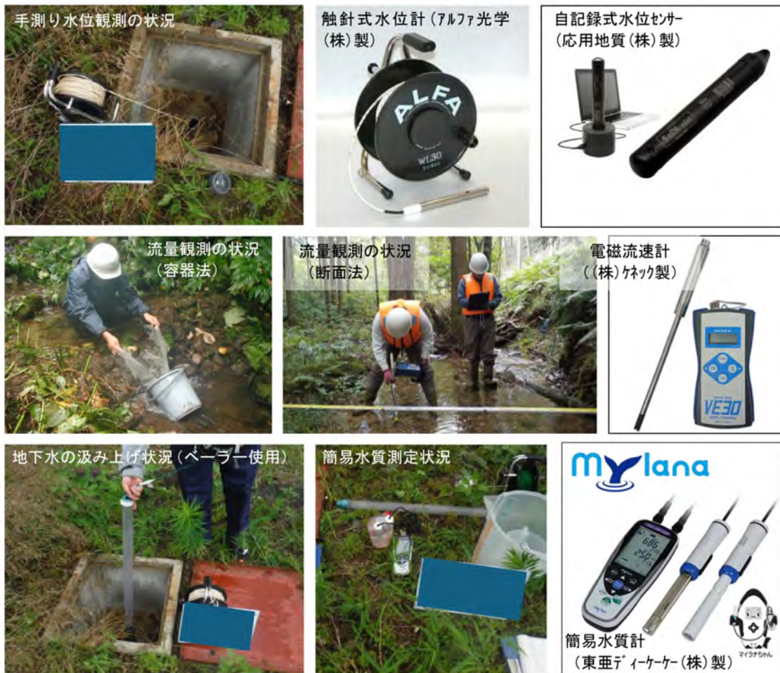
図5 モニタリング（水位、流量、簡易水質）の実施状況と機器例
