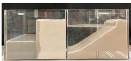
図 11.2 ベントナイト安定液の崩壊防止実験 ベントナイト安定液で砂の壁面が薄いシート状のベントナイトで安定化され崩壊を防止し自立する
