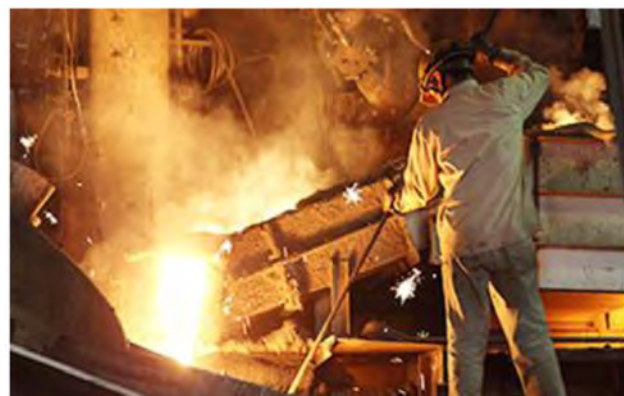
図 12 1500℃で出湯される溶湯(鋳鉄)
