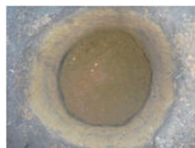
写真-1 盛土地盤における試験孔掘削後状況
