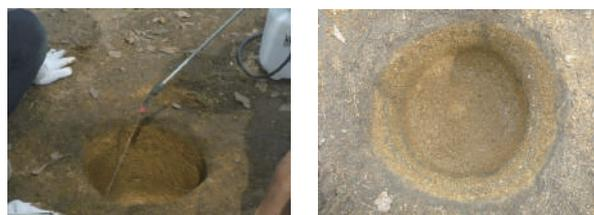
写真-2 霧吹きを用いた洗浄後の試験孔
