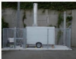
図1（左）水蒸気ライダーと（上）観測例。つくばの水蒸気ライダーを用いて観測した2016年9月1日の水蒸気混合比の時間高度分布。(Sakai et al. 2019から転載。(Licensed under CC BY 4.0))
