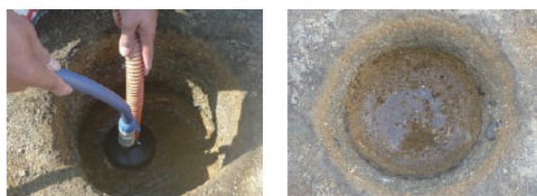
写真-3 洗い流しによる洗浄後の試験孔
