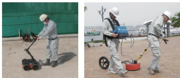
写真1 ハンディ型地中レーダ装置による探査
