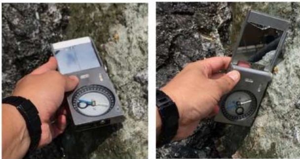
図2 クリノメーターによる走向と傾斜のはかり方 3,4,5) ((A), 左写真: 走向, (B), 右写真: 傾斜)
