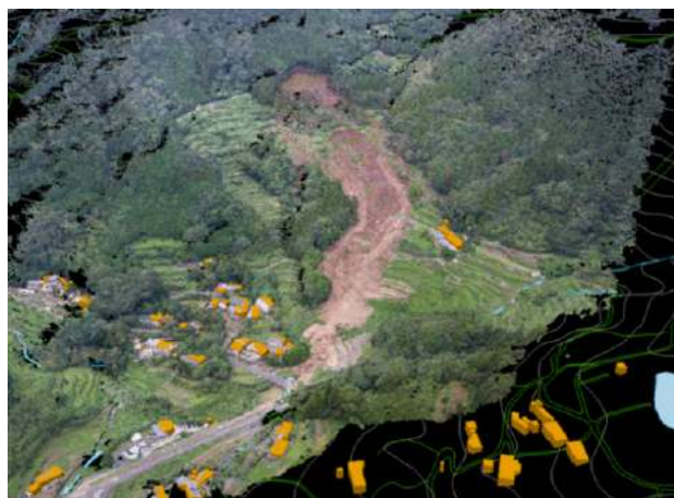
図 5 地すべり災害対応の BIM/CIM モデルの例 (長崎県牧の地地区)
