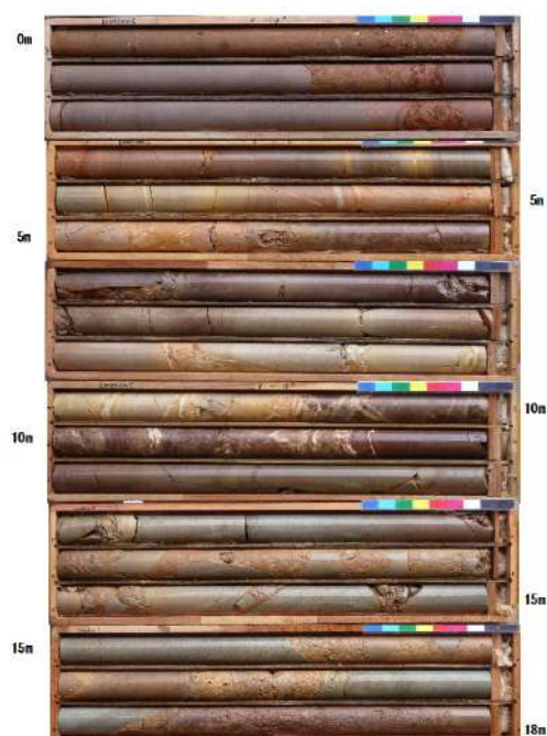
写真-9 高品質ボーリング (ハイブリッドボーリング工法) のコア状況、巨礫を含む崖錐堆積物。巨礫のサイズは最大2m、基質は礫混じり粘土。
