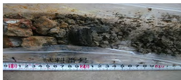
写真 BV-1 標準貫入試験試料（深度 20m）の木片（写真中央）
