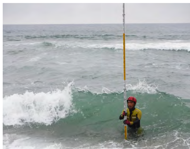
図-2 人による汀線測量
