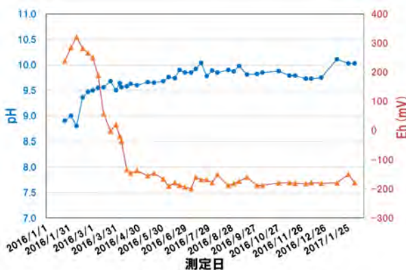
図8 冠水坑道内のpHと酸化還元電位(Eh)の変化
