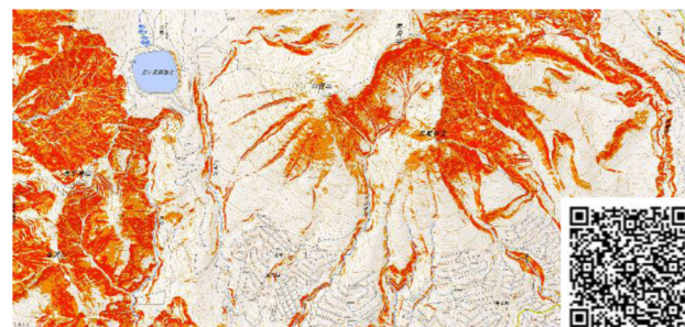
図-8 全国傾斜量図(雪崩関連)
