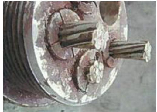
図-18 新タイプアンカーの変状 14)
