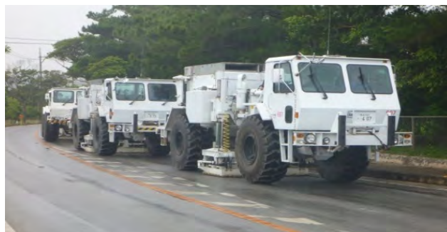
写真 1 バイブロサイズによる反射法地震探査（宮古島）
