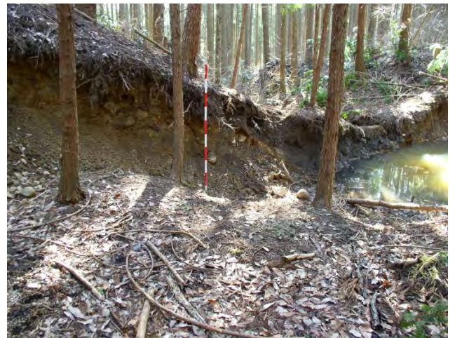
写真 1 井戸沢地震断層の出現と沢の堰き止め
