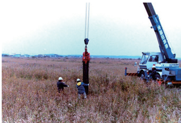
写真4 霧多布湿原での大型サンプリング（2004年10月） 先端に歯を付けた既成の鋼矢板を振動させながら打ち込み、もう一枚の鋼板を被せるように打ち込んでサンプリングする。
