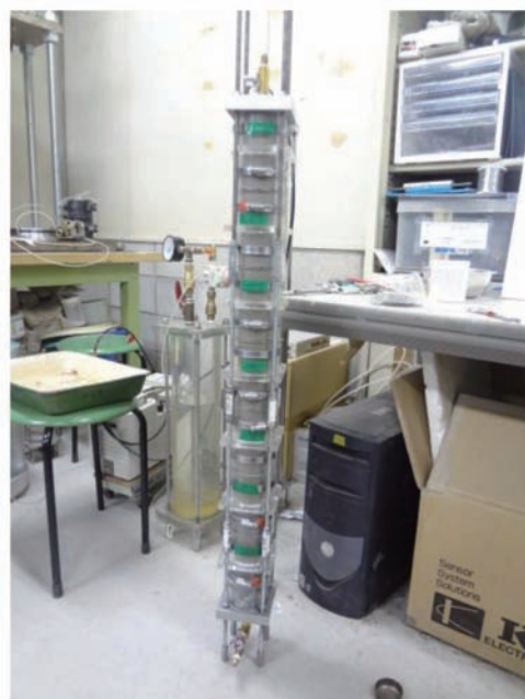
写真1 室内浸透試験装置の外観 5), 6)
