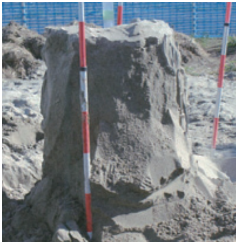
図6 微生物と炭酸塩による砂の固化 15)
