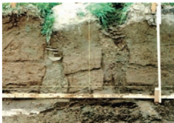
写真1 せたな町北檜山区後志利別川下流の水田で液状化現象を観るためのトレンチ調査(1993年9月) 20cmほどの砂脈が2本見える。砂だけでなく礫も噴出している。
