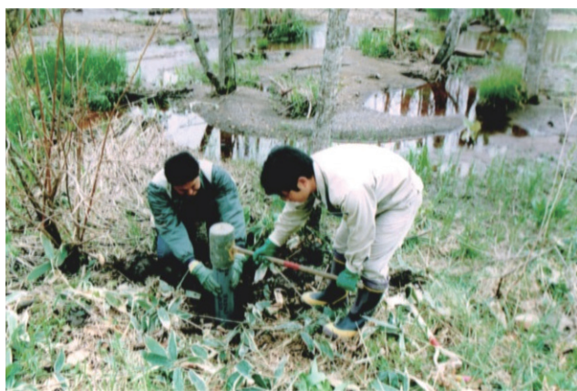
写真5 湿地での塩ビパイプによるサンプリング（2000年5月） ピットを掘るよりも効率的に試料採取ができる。ただし、せいぜい深さ50cmまでである。
