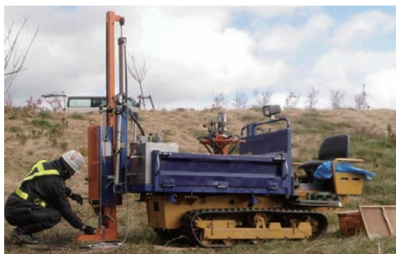
写真3 ミニラムをクローラーに搭載した仕様のPDC
