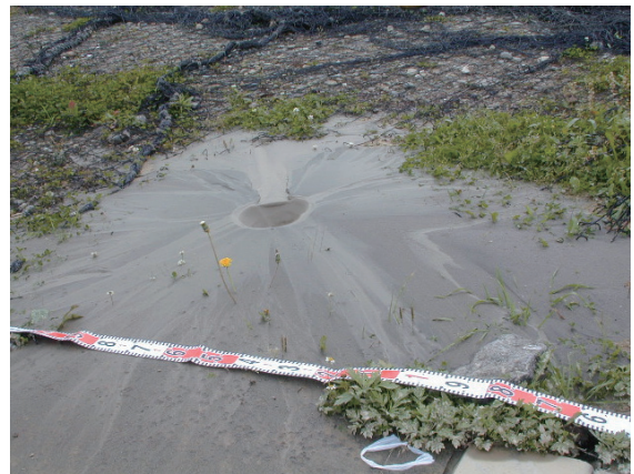
写真-1 2003 年十勝沖地震における十勝港における液状化の代表的事例（撮影：著者）
