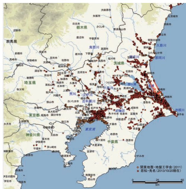
図5 東北地方太平洋沖地震による関東地方の液状化発生地点 注)
