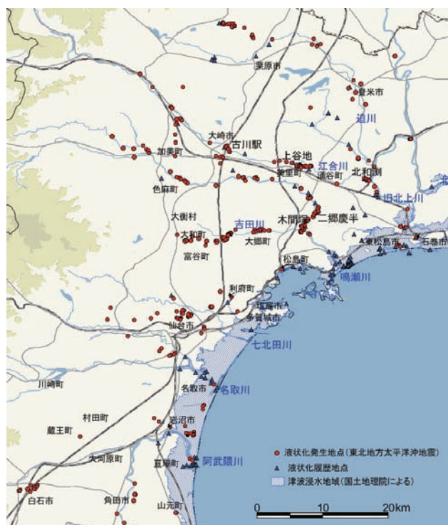
図2 宮城県の液状化発生地点と過去の液状化履歴 1) および津波浸水域 3)
