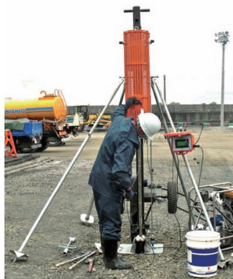
写真2 スウェーデン式ラムサウンディング（SRS）仕様のPDC（試作機）
