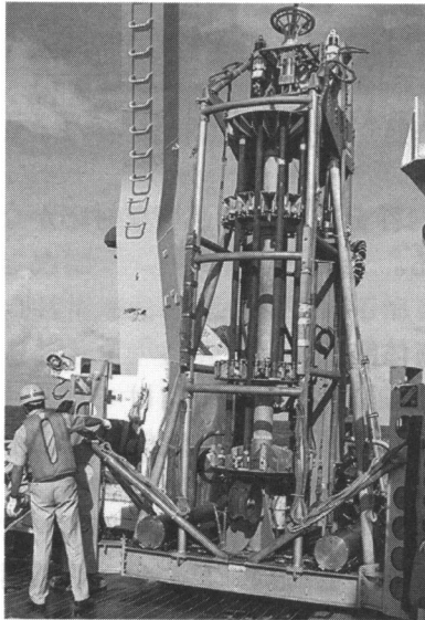
写真1 深海用ボーリングマシン（従来の機械では，海底下最大20mまでの掘削が限界）
