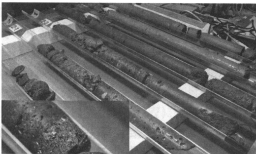
写真2 深海用ボーリングマシンで採取された海底熱水鉱床コアの一例
