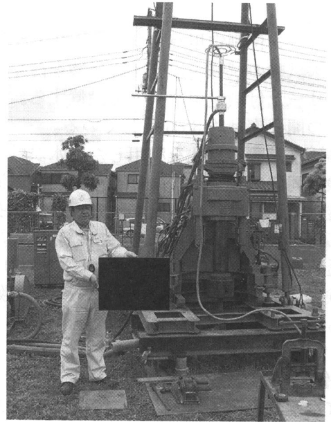
写真5 透水異方性調査に用いる大型ボーリング機械
