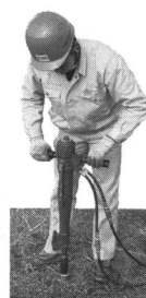
ポータブル 表層土壌調査機 ハンディECO 表層土壌汚染調査 など
