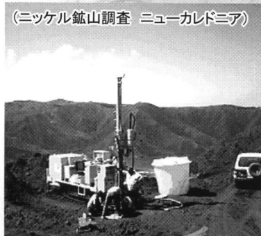
ワイヤーライン工法用削孔機 TYW-50
