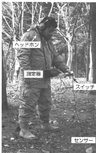
写真1 地下流水音の測定の様子
