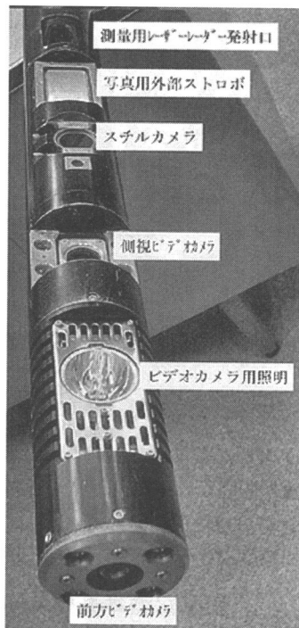
図2 空洞カメラの概要
