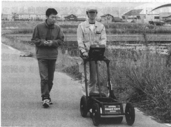
写真7 スマートカートシステム地下レーダ
