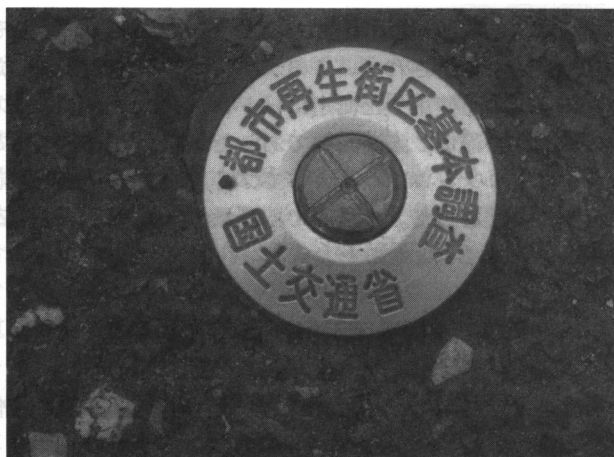
写真3 都市再生街区基本調査により設置された測量基準点
