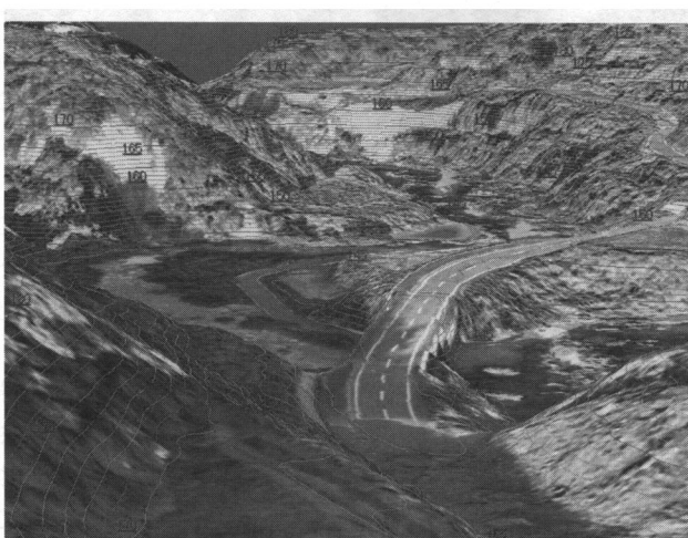
図7 河道閉塞箇所のレーザデータとデジタル写真による1 m コンター鳥瞰図
