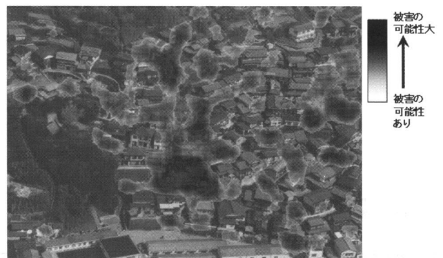
図11 災害被災箇所の自動抽出例 7)
