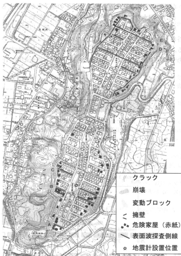
図6 新潟県中越地震による長岡市高町団地の被害
