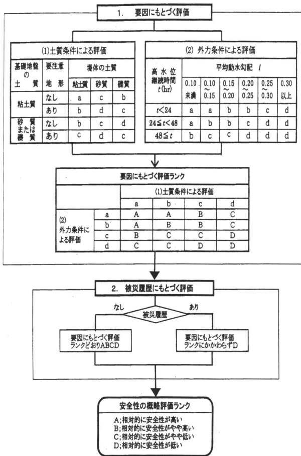
図1 概略点検の流れ（要因(1)土質条件と(2)外力条件による評価からランクA～Dの4段階評価後、被災履歴の有無による、安全性の概略評価ランク決定の流れ）
