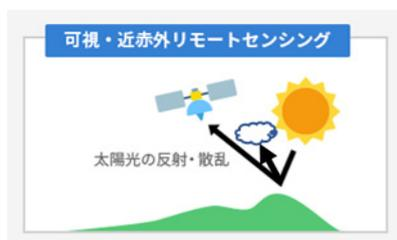
図 3.2-1 可視・近赤外リモートセンシングの仕組み
