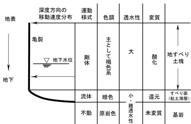
図6 地すべり斜面の構成<sup>2)</sup>
