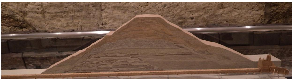
写真1 堤体断面の模型
