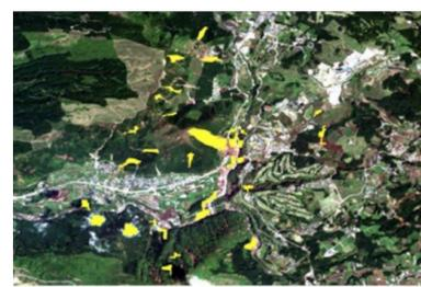
図 3.2-3 土砂災害の抽出例 (黄色が土砂崩落域)
