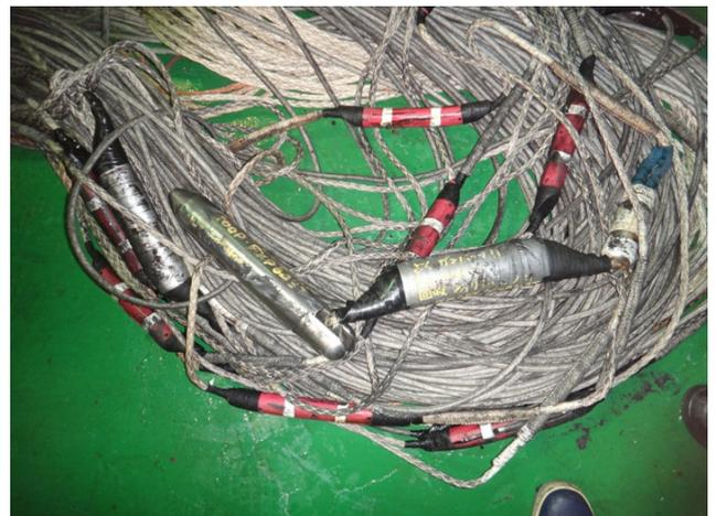
図6 約9か月の観測を終え、水深6,897.5m、海底下深度854.81mの孔内から回収された55個の小型温度ロガー
