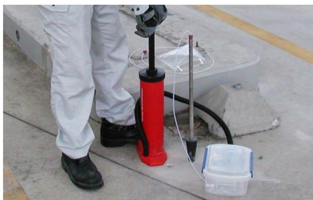
図-3 捕集バッグ法によるガス採取状況の例
