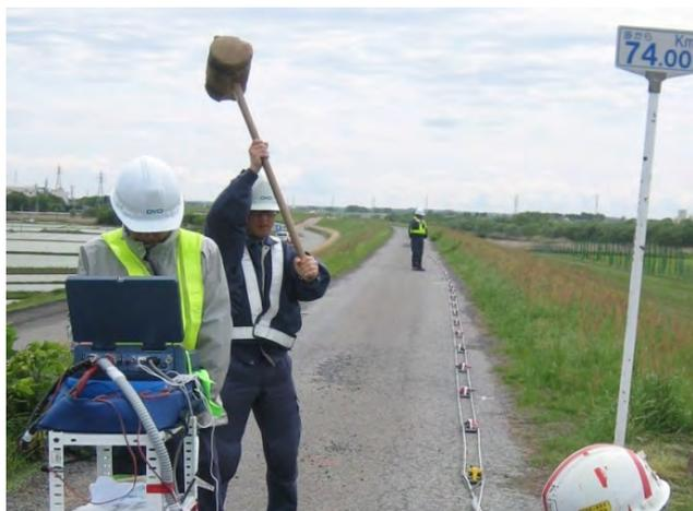
写真1 ランドストリーマー方式表面波探査
