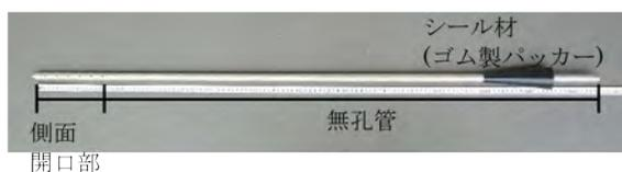
図-1 ガス採取保護管の例
