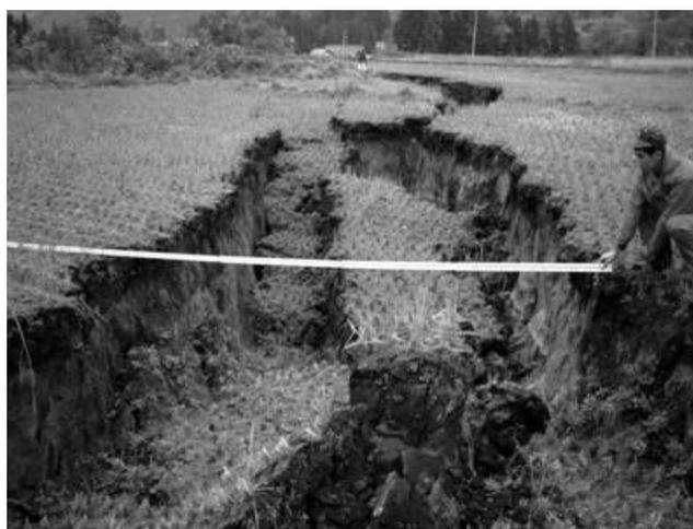
図-4 柱房式採掘箇所の陥没事例
