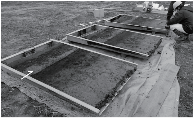
図3 仙台市における津波堆積物の採取風景 白い矢印で示した地層が貞観地震に伴った津波堆積物 (澤井, 2014b) 33)
