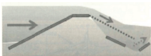
図-6 三面張防潮堤の被災形態
