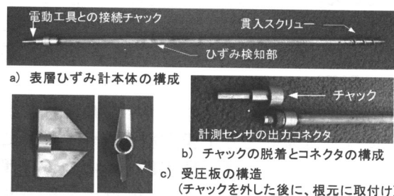
写真2 スクリュー貫入型表層ひずみ計 (SPS) の外観
