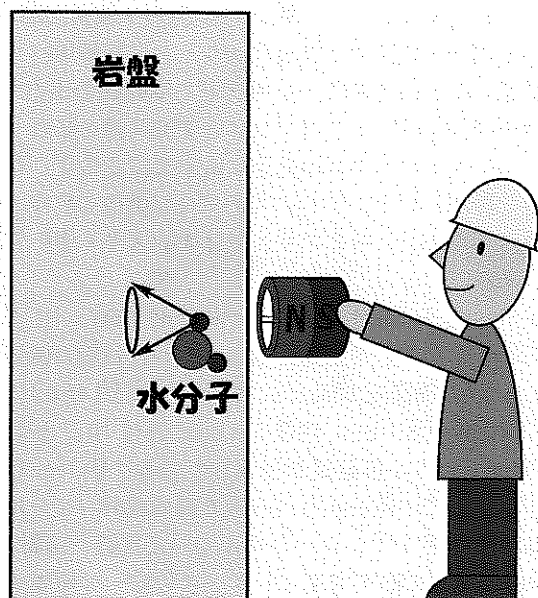
図 1 NMR 表面スキャナーによる岩盤検査の概念図。永久磁石を近づけて多孔質岩盤の間隙水の水分子中の水素原子核を歳差運動させ、その歳差運動をコイルで検出する。
