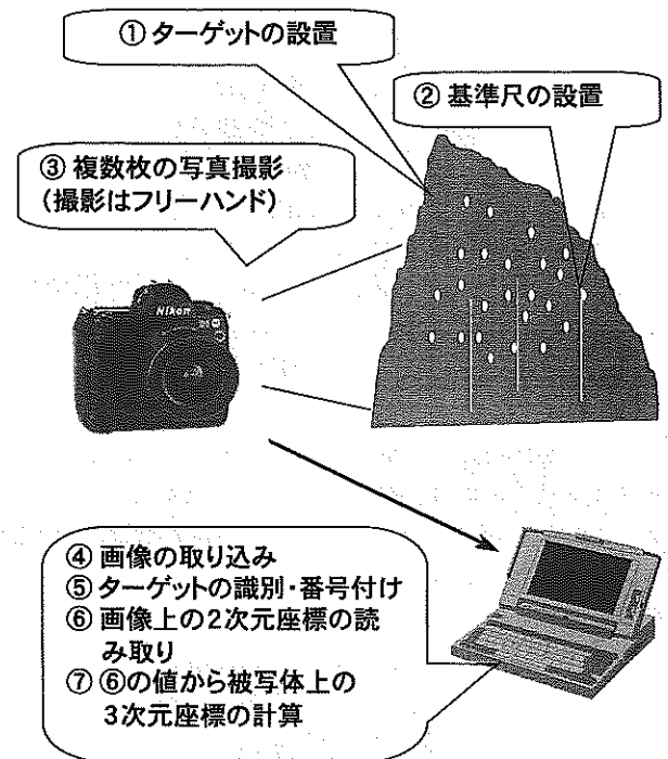
図8 精密写真測量による計測手順
