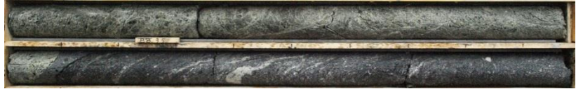
図 3.2.8 高品質ボーリング（断層）の例
