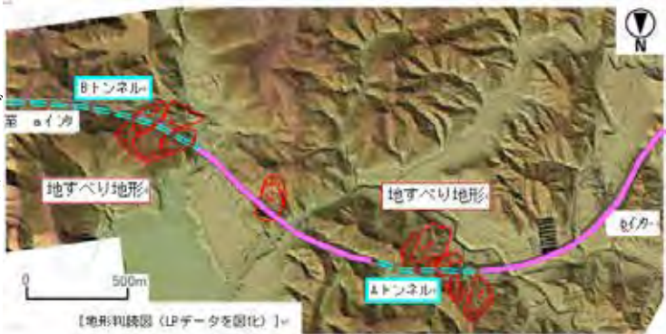
図 1 Aトンネル・Bトンネルを横断する地すべり地形
