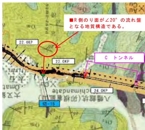
図4 流れ盤構造となる切土のり面(切-15地点)
