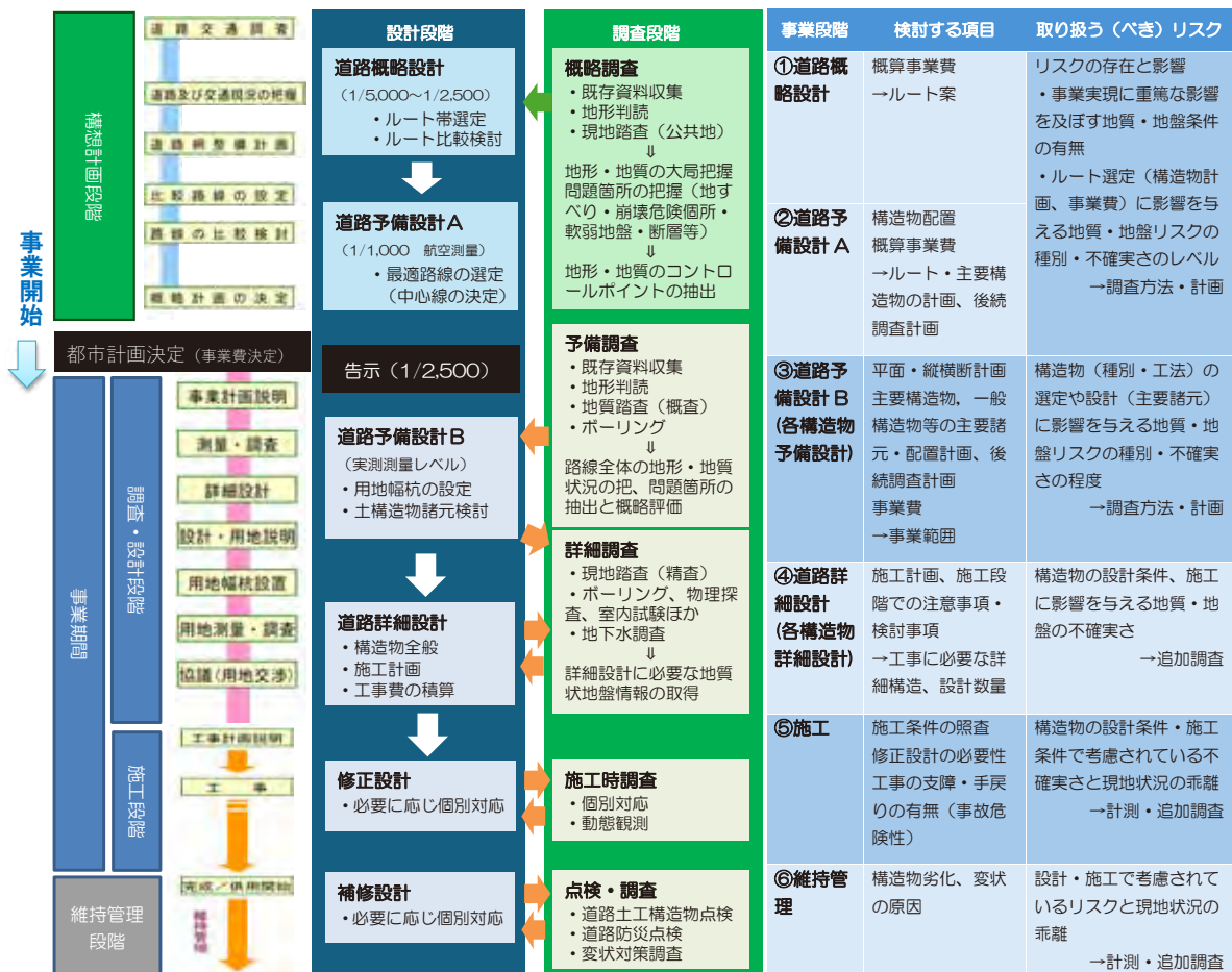
図 3.1 道路における各事業段階の検討項目・取り扱うリスク(文献 1) を加筆修正)
