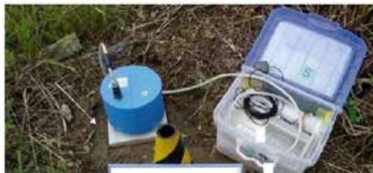
地震計設定例（出典：新版物理探査適用の手引き, 2008 より）
