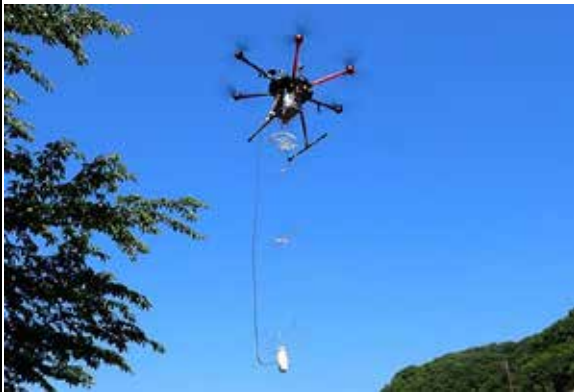
ドローン空中電磁探査 (D-GREATEM)
