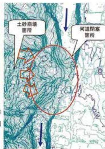
図 河道閉塞箇所の等高線図
