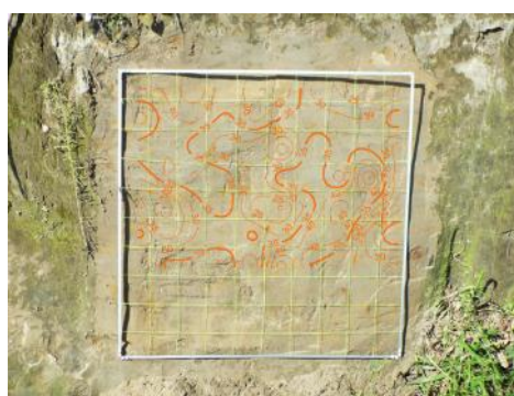
泥岩露頭のクロム濃度分布の整理例
