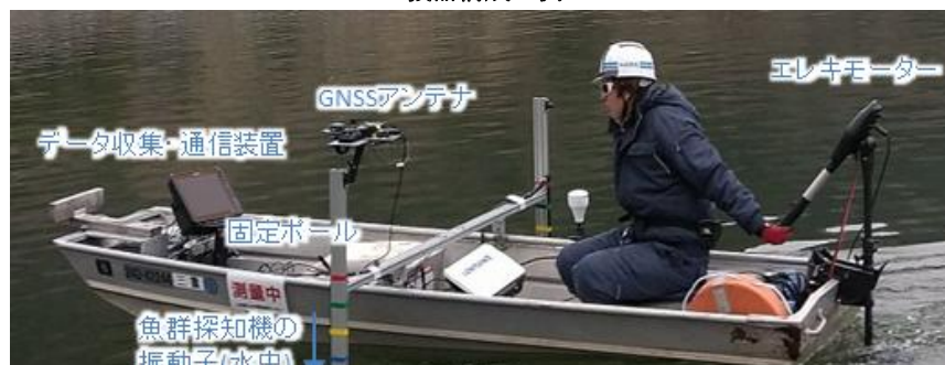
計測状況の例
