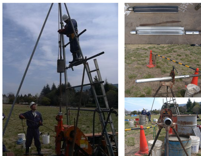
図- 6.1-2 標準貫入試験の風景
