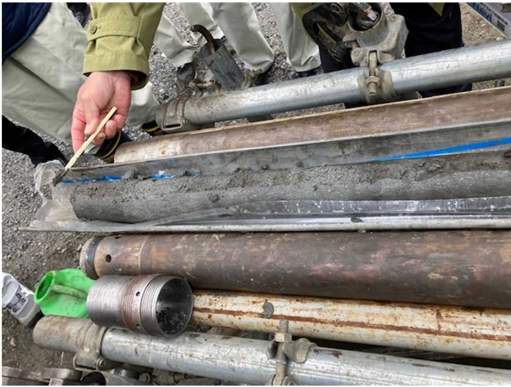
N値 7~8 回のルーズな砂質土の採取コア（採取率 100%、堆積構造も確認）
