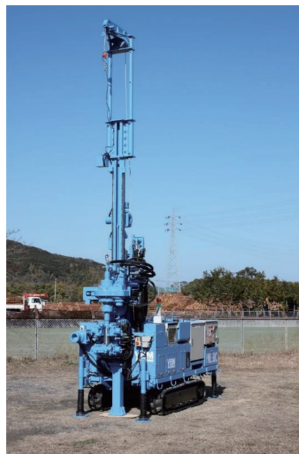
図2-1 全自動ボーリングマシン試作機
