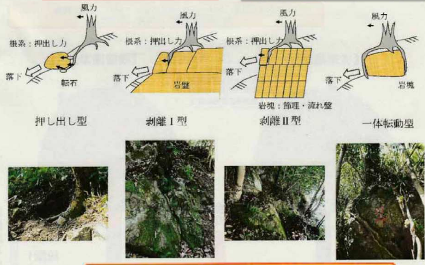
図-5 樹木と根系の成長による落石形態
