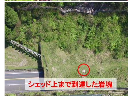
国道210号(大分県日田市): 落石 本震(近傍で震度4)より約5時間 遅れて発生 ほとんどはリングネットで捕捉 (1個のみシェッド上に到達)
