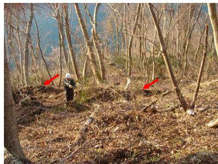
さらに上部に変状を生じた斜面 赤矢印：斜面内に生じた亀裂
