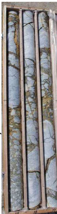
右写真：崩壊部より斜面上方のコアには、深部にも流入粘土あり（緩みあり）。
