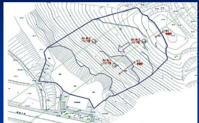
平面図 斜面の亀裂・段差
