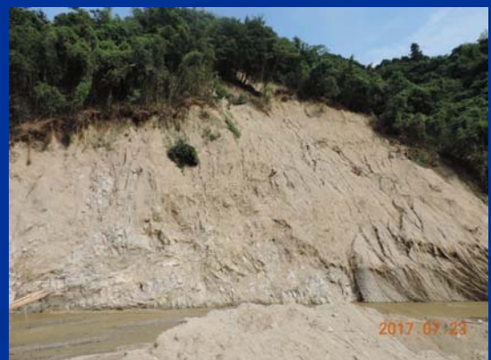
河床付近の弱風化部から強風化部へ
